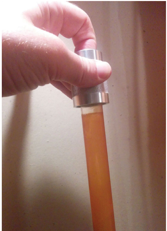
Assurez-vous de nettoyer à intervalles réguliers la gaine de l'ampoule ultraviolette. Si la gaine est sale, il se peut que les rayons ultraviolets ne puissent pas inactiver comme il se doit les germes dans l'eau, qui est contaminée parce qu'elle n'est pas traitée.
